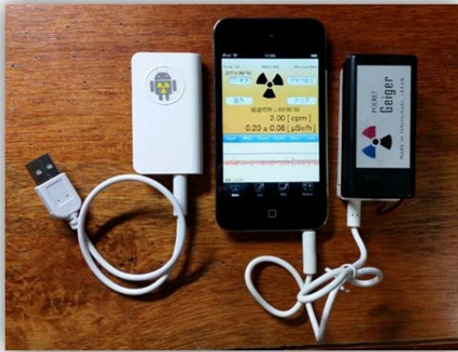
ポケットガイガーと呼ばれる 簡易な放射線（γ線）測定器
